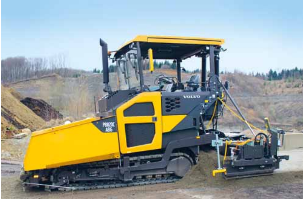
Volvo-Kettenfertiger mit Doppelstamperbohle
