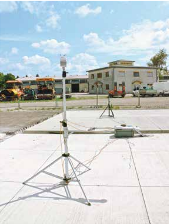
Abbildung 11: Messeinrichtung zur Bestimmung der Strahlungsbilanz, der Lufttemperatur sowie der Windgeschwindigkeit und -richtung
